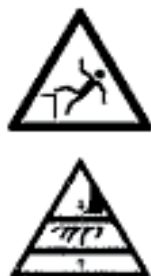
Riesgos de caída y aplastamiento.
